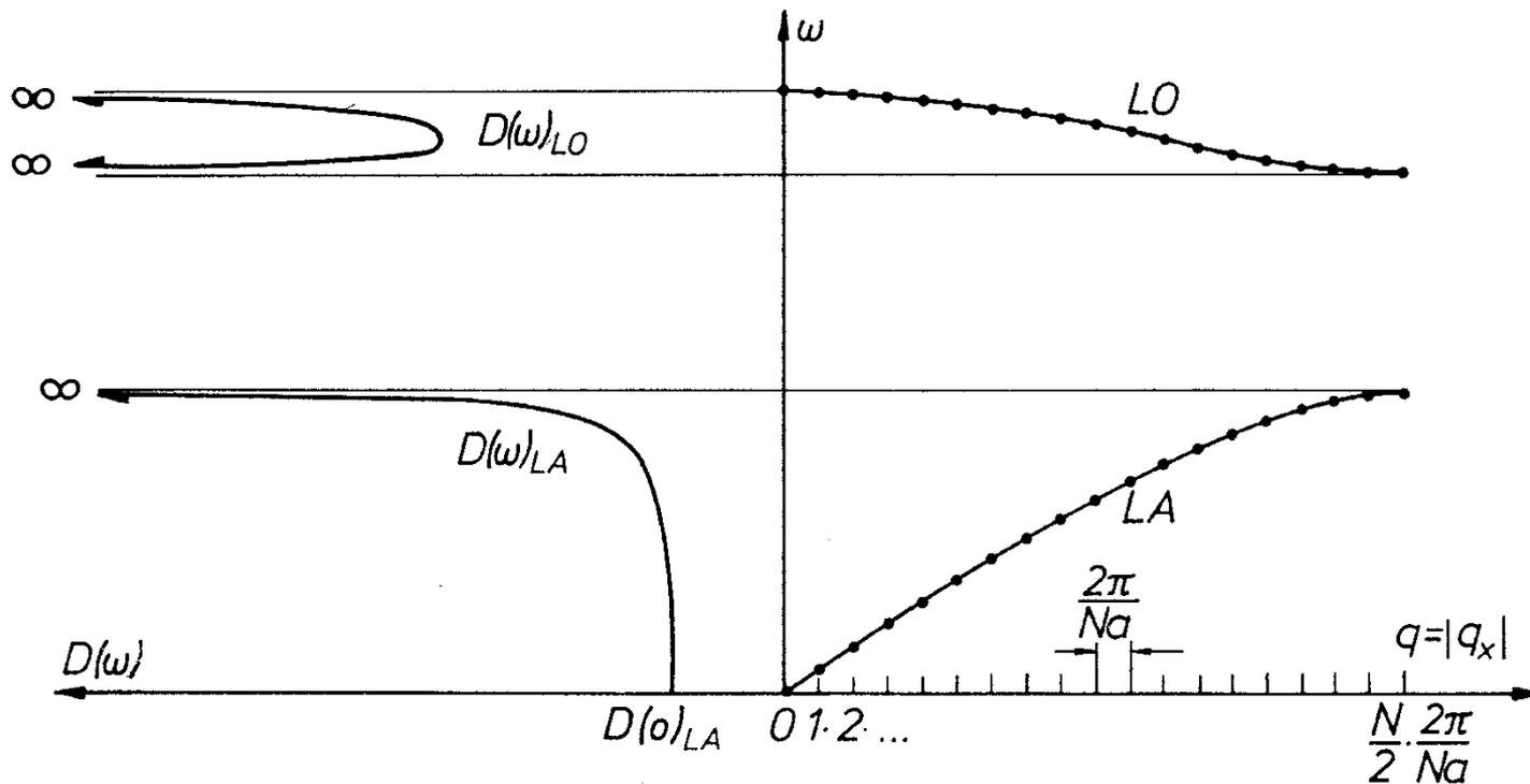
Longitudinal waves in a linear AB-chain
